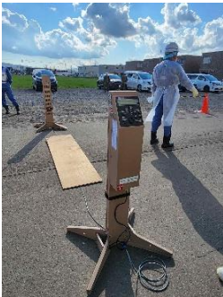
バスの表面汚染を測定するモニターです
